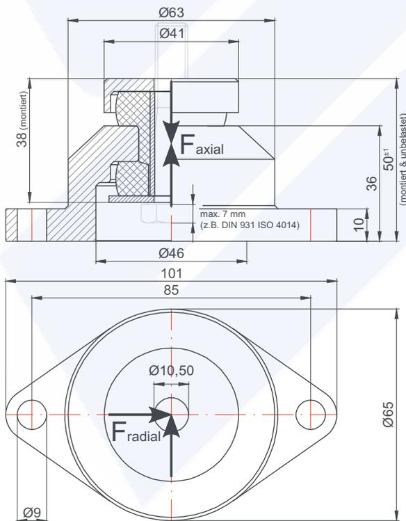
Die Angaben für Federeigenschaften und Eigenfrequenzverlauf sind Anhaltswerte und können aufgrund der Fertigungstoleranz der Elastomere etwas abweichen.
